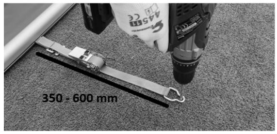
9. Wir verspannen die Abdeckung mit der Spannklammer.
